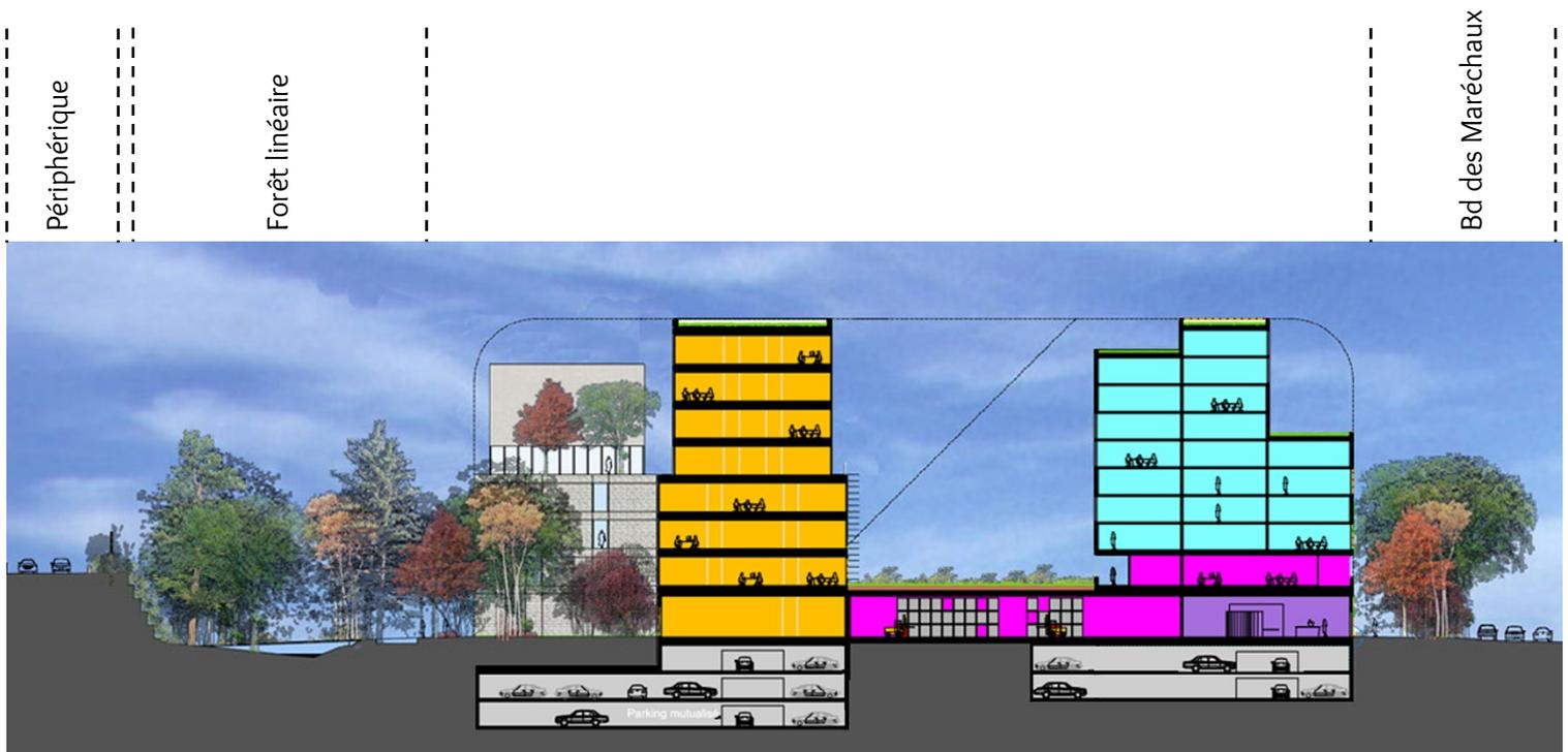
Coupe de principe d'implantation du bâti : bureaux écran, logements sur le boulevard, rez-de-chaussée commercial et activités.
