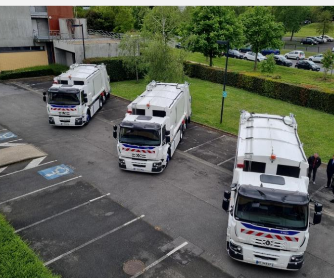
Figure 17 : BOM 26T électriques
