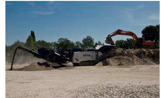
→ Installation mobile de concassage des matériaux de déconstruction
