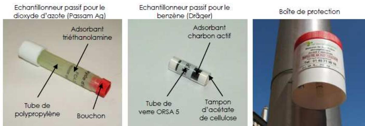
Figure 124 : Description des systèmes de prélèvement
