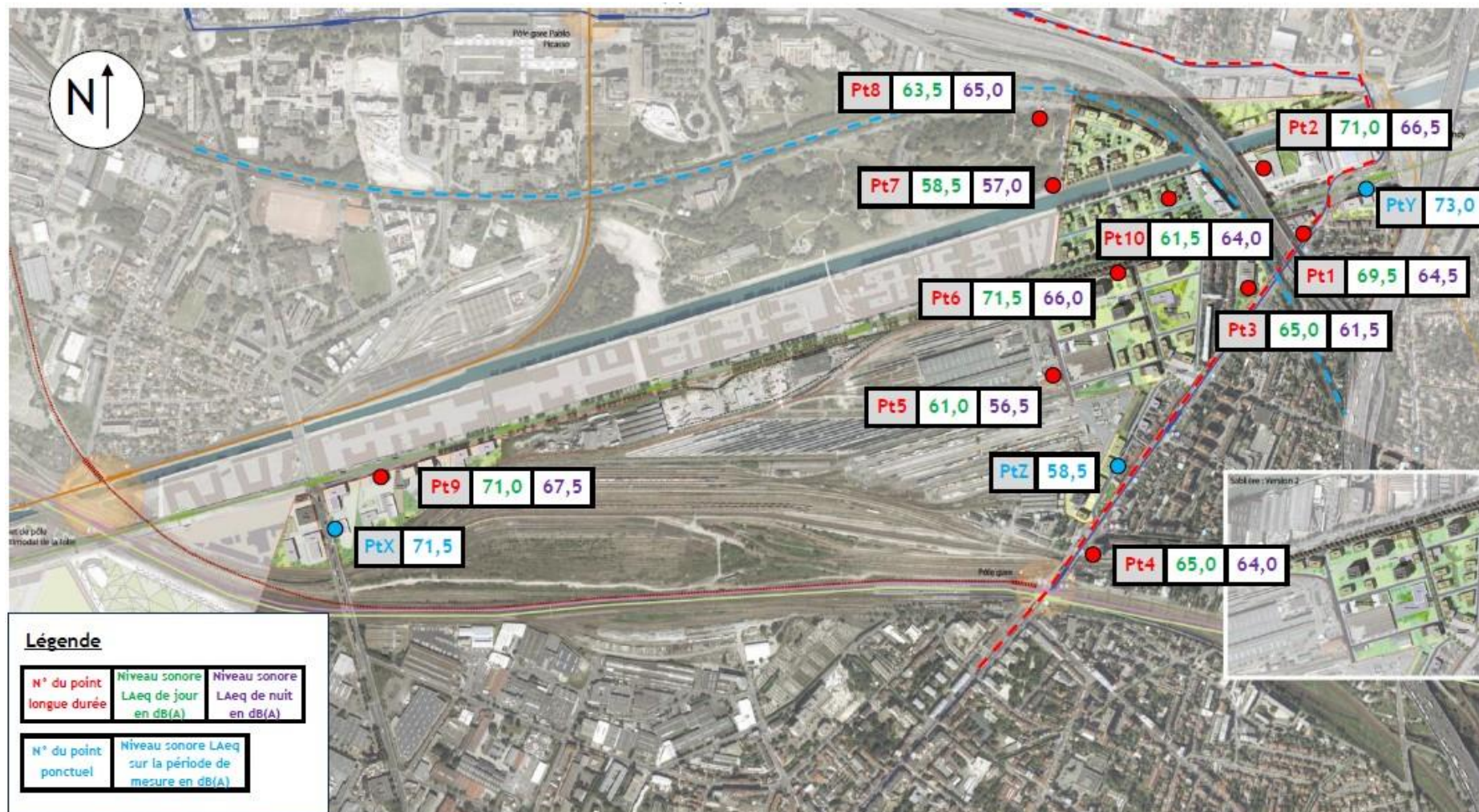
Figure 93 : Résultats des mesures LAeq jour et nuit en dB(A) en considérant la contribution du bruit routier ET ferroviaire (Alhyange Acoustique, 2015)
