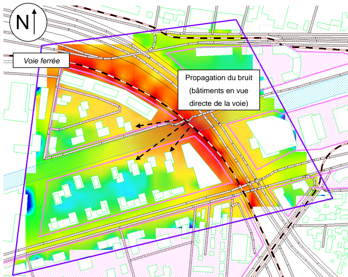
Figure 147 : Impacts sonores du trafic routier et au passage d'un train sur la voie ferrée de fret, suite à l'aménagement de la future ZAC en période de nuit (22h – 6h) (ALHYANGE Acoustique, 2015)
