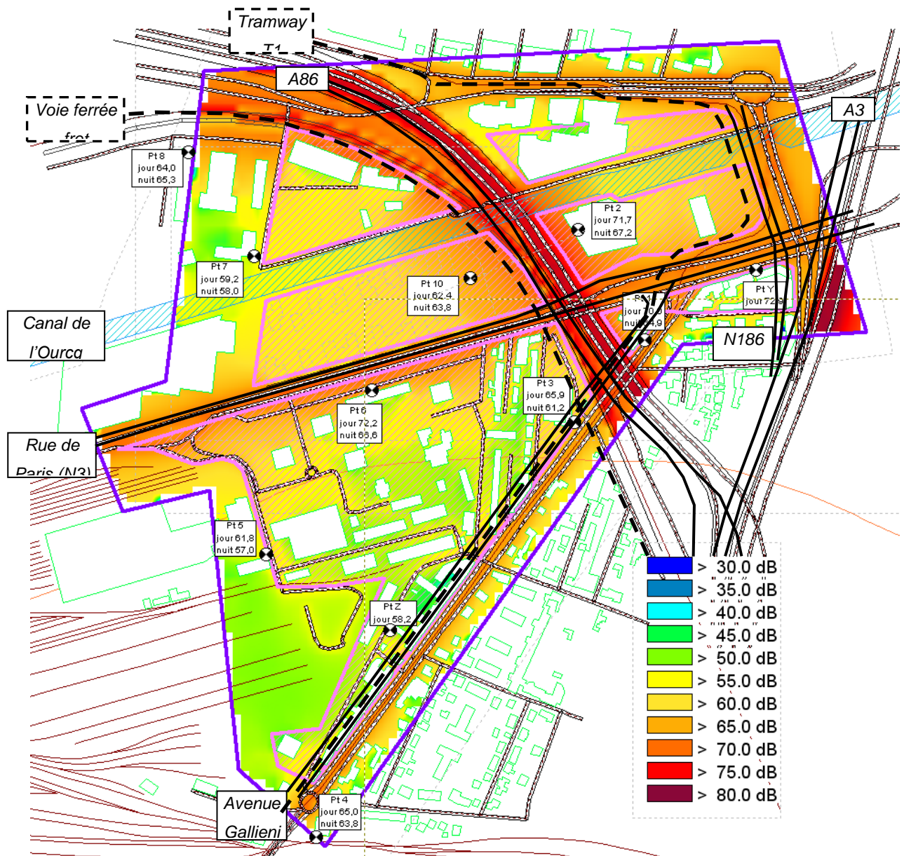
Figure 97 : Bruit ambiant induit par les voies routières et ferroviaires à l'état initial en période de nuit (22h – 6h) (ALHYANGE Acoustique, 2015)
