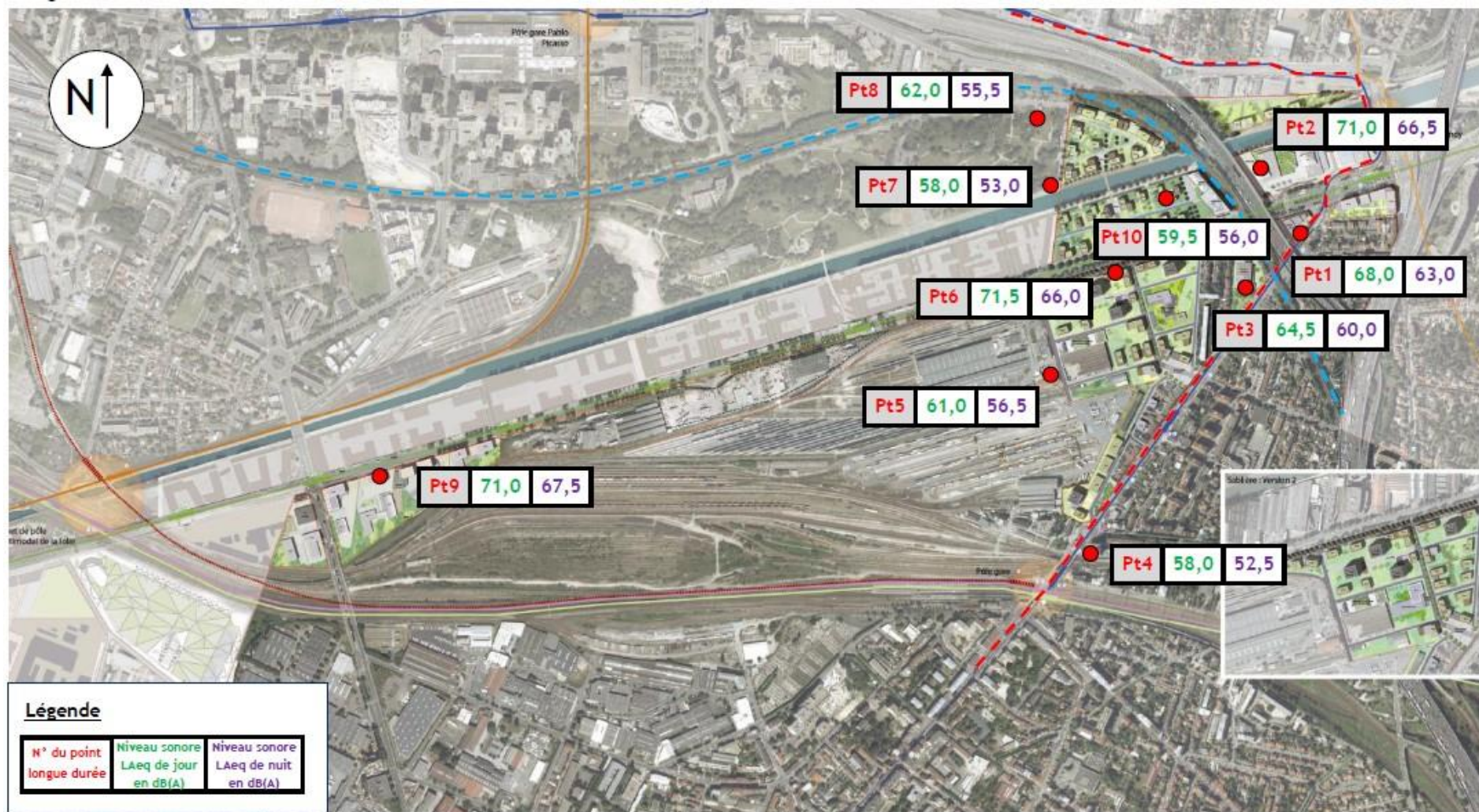
Figure 94 : Résultats des mesures LAeq jour et nuit en dB(A) en ne considérant que la contribution du bruit routier, et en retirant les bruits identifiés d'origine ferroviaire (Alhyange Acoustique, 2015)
