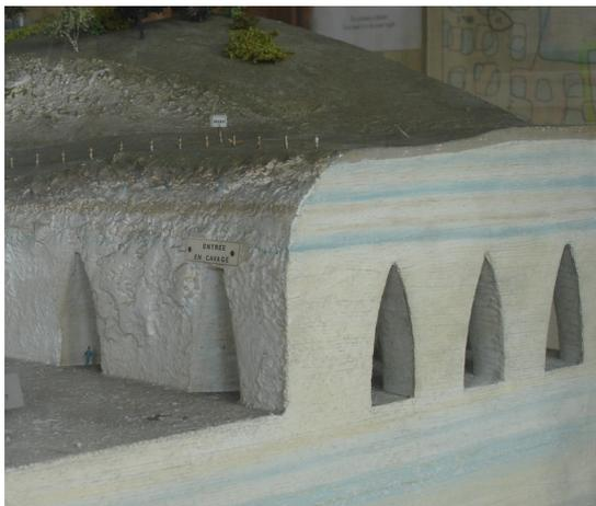
**Photo 1 : Maquette de l'Inspection générale des Carrières montrant une carrière de gypse ludien à ciel ouvert**
