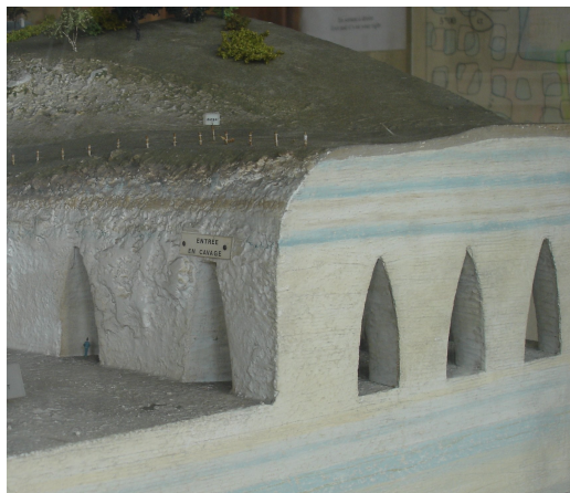
Photo 1 : Maquette de l'Inspection générale des carrières montrant une carrière de gypse ludien et de marnes à ciment à ciel ouvert
