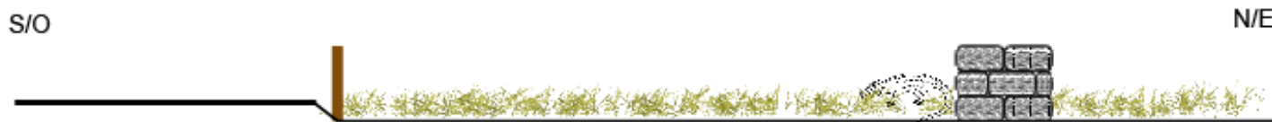
Coupe montrant l'aménagement d'un muret en pierre
