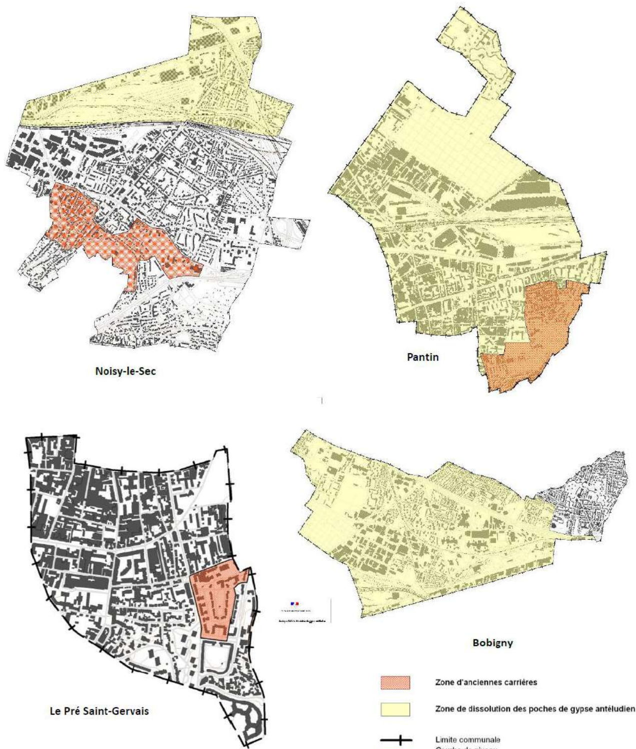
Figure 3-58 : Périmètres de risque lié à la dissolution du gypse (source : DDT 93)
